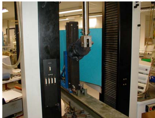
Seitlich an einem Bodenträger ziehende Vorrichtung. Der Bodenträger besteht aus einem runden Sockel, einem runden Kopf ohne Auflageteller mit Plattentrennflügeln und zwei Muffen.
