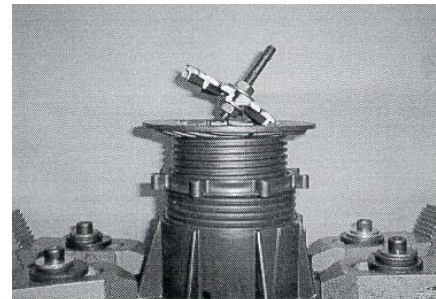
Foto Nr. 5 Die Verankerung bleibt fest am BUZON-Sockelkopf DPH5
